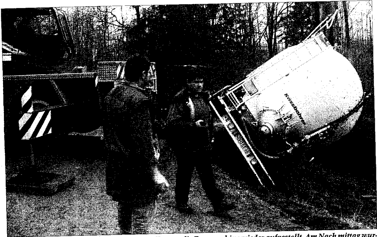
Mit Seilwinden haben Arbeiter der Firma Saller erst die Zugmaschine wieder aufgestellt. Am Nach mittag wurde dann der 32 Tonnen schwere Auflieger von einem Autokran aus dem Graben gehoben. (Fotos: Schiller)
